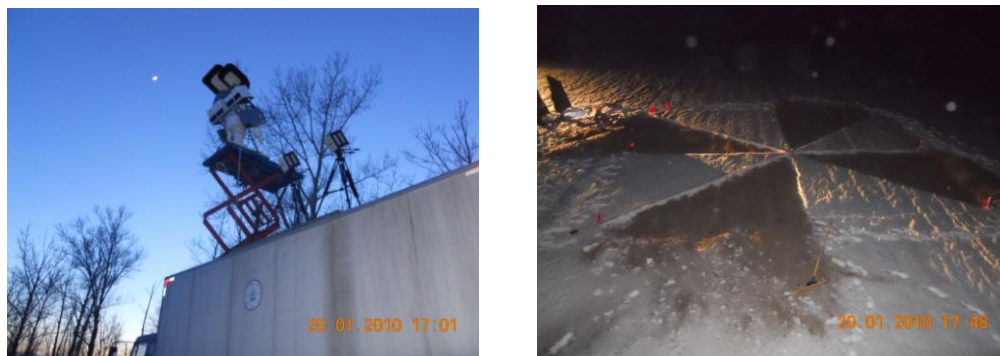
图 3.7 微波辐射计架设在北师大遥感车上在大豆地（样地 4）进行混合像元探测
