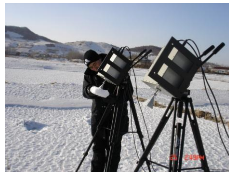
图 3.16 积雪样品辐射特性测量
