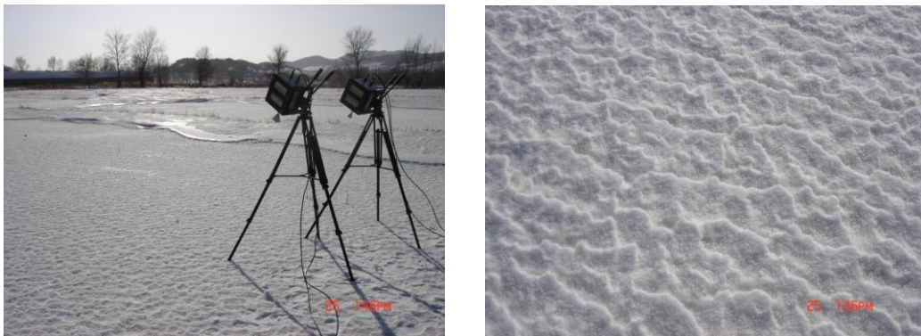
图 3.10 水田积雪微波辐射测量
